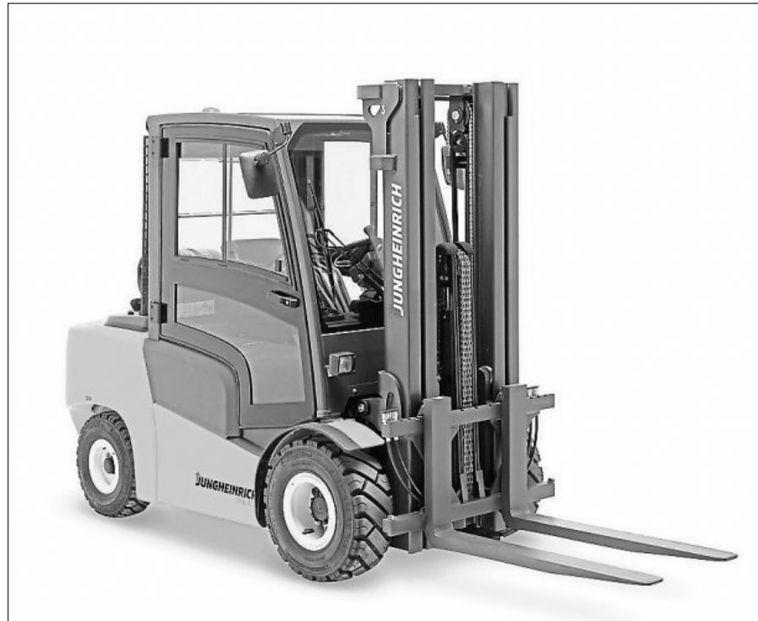
Die Jungheinrich-Stapler können Lasten von bis zu 3500 Kilogramm transportieren. (Foto: Jungheinrich)
